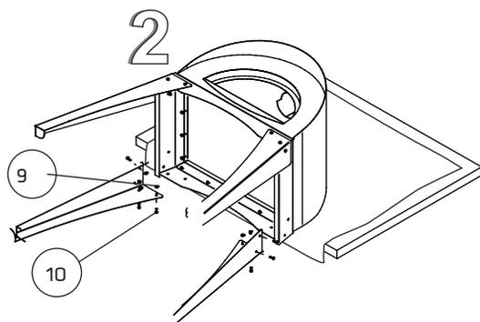
Instalar las dos patas frontales utilizando los pernos y las tuercas indicados. Se debe tomar en cuenta que la sección curva de las patas debe ir mirando hacia atrás.
